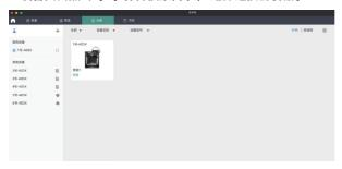
2. 局域网模式下连接打印机需打开打印机【网络模式】-【局域网模式】,切片软件在设备页点击【+】 找到对应打印机。选择相应打印机并输入打印机上的设备ID完成连接。
